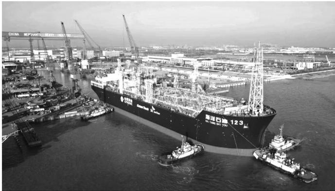
船长 241.5 米，型宽 45.2 米，型深 25.4 米，甲板面积相当于 1.5 个标准足球场大小，我国首艘全新智能 FPSO（浮式生产储卸油装置）来了！
