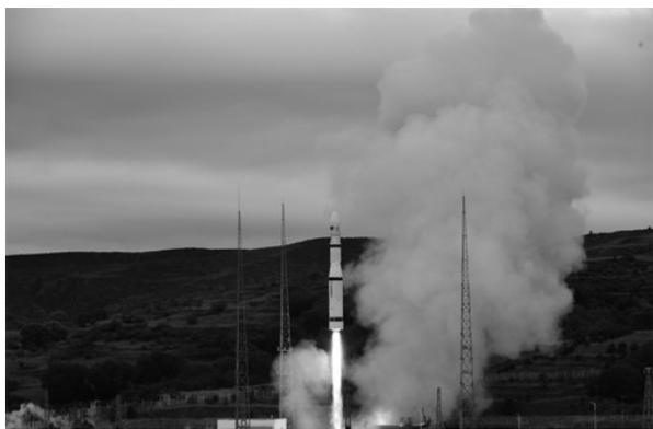
长征六号运载火箭由中国航天科技集团有限公司八院抓总研制,是我国新一代无毒、无污染液体运载火箭,具备发射多种类型、不同轨道要求卫星的能力,可实施一箭单星或多星发射。其太阳同步圆轨道运载能力可达1.0吨(轨道高度700公里)。
